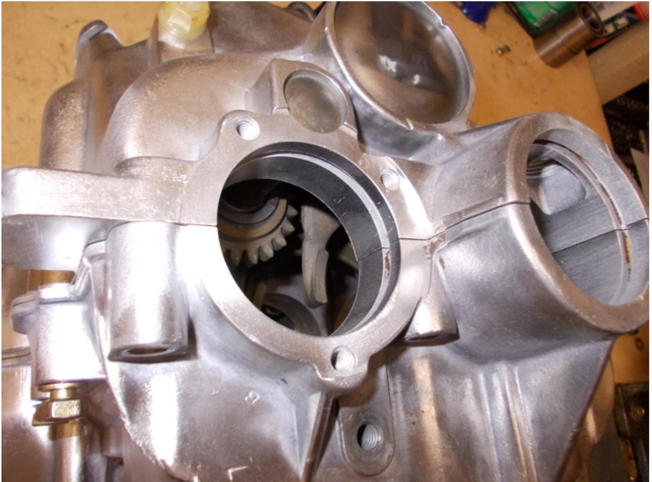
Diese Gehäuse können auch für "normale" Getriebe verwendet werden, dafür müssen nur die 3 Gewinde am Ausgang für die Hycomatpumpe verschlossen werden, wenn sie nach innen durchgebohrt sind, weil hier sonst Öl ausläuft. Und der offene Abschlusdeckel (da geht die Antriebswelle vom Motor her durch) muss gegen einen geschlossenen getauscht werden. Andersherum klappt das nicht, Hyco braucht Hycogehäuse.
