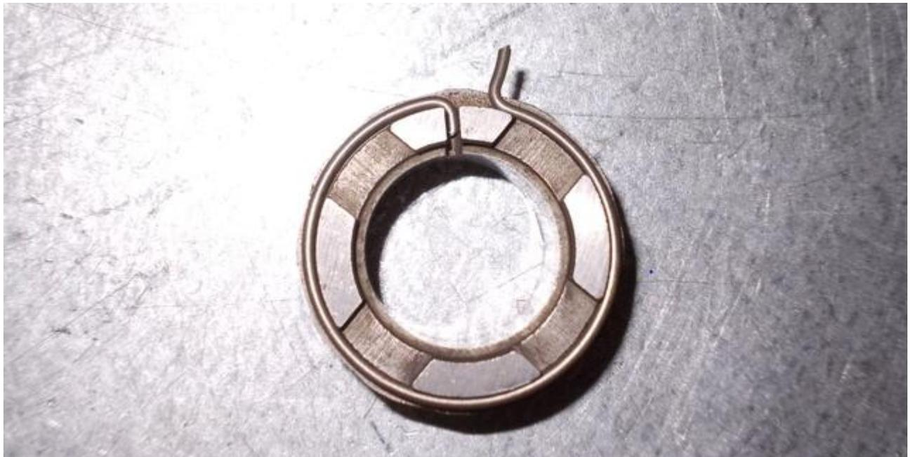
Die Freilaufkörbe unterliegen auch einem, aber geringen, Verschleiß. Wenn die Fenster schon sehr blank sind und keine Stanzmarken mehr erkennbar sind wird auch er ausgetauscht.
