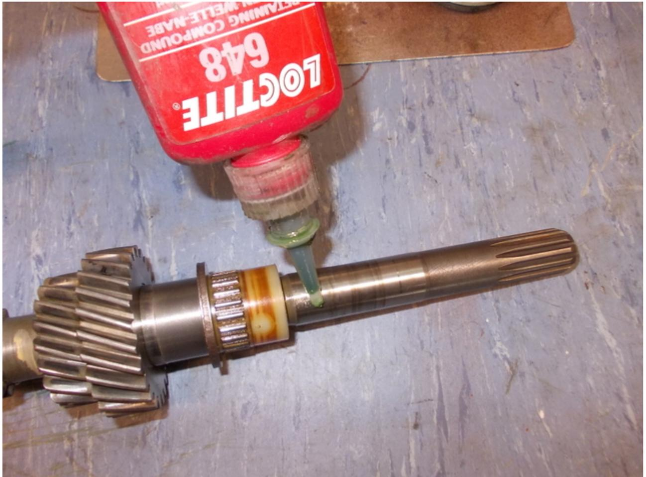
Nun alle Teile auf die Welle schieben, aufpassen, daß der Freilauf nicht wieder herausrutscht. Die Ölleitscheibe hat innen scharfe Abdrücke vom Freilaufstern, die zeigen wie er drauf gehört. Sie muss sich zum Freilauf hin wölben.
