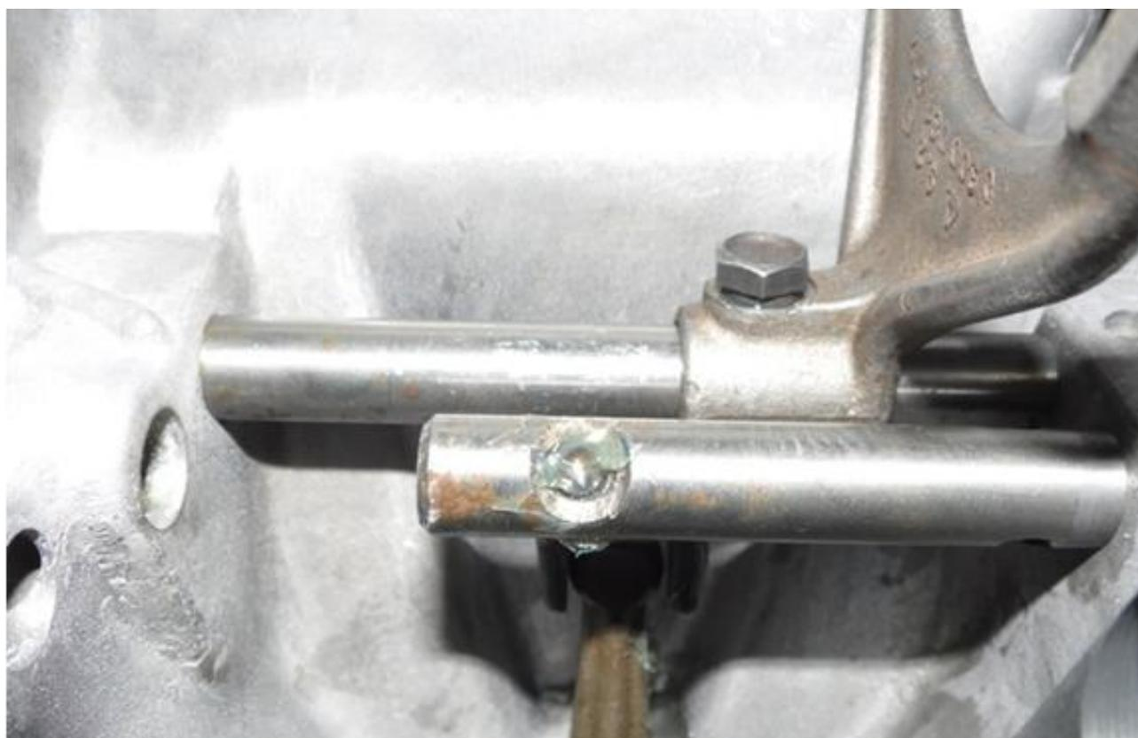
Anschliessend wird die 2. der 10mm-Kugeln (in der oberen der 3 Bohrungen noch sichtbar) mit etwas Fett in den Gehäusequerkanal zwischen Stange 1.-2. und Rückwärtsgang eingelegt.
