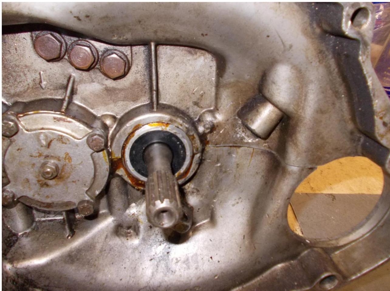
Die 4 Schrauben M6 des Deckels für die Abtriebswelle und den Deckel selber entfernen. Die Mutter in der Mitte bleibt drauf, damit ist die Ölförderschnecke am Deckel innen befestigt.
