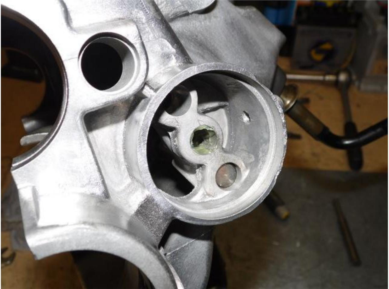
In diesen Kanal wird nun die 1. der 10mm-Kugeln eingelegt. Sie ist dann nicht mehr sichtbar denn hier auf dem Bild muss sie noch nach unten fallen.
