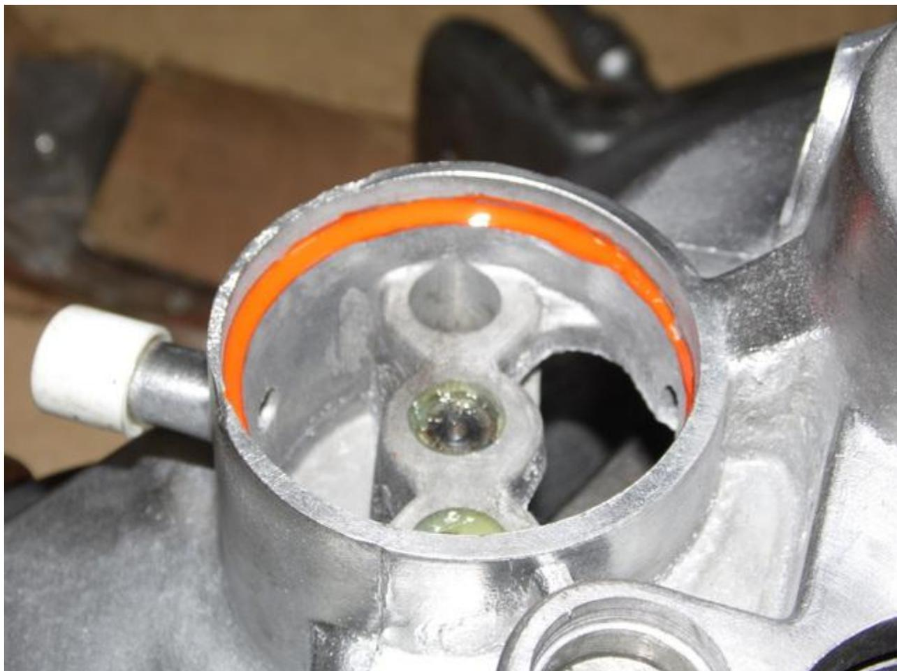
Dann die Deckel mit der Wölbung nach aussen einsetzen und in der Mitte (beim großen direkt mit einem Kunststoffhammer, bei den kleinen mit einem Dorn) auf die Deckel schlagen bis sie sich im Gehäuse verkeilen.
