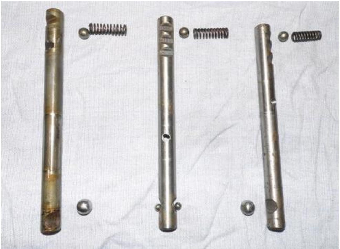
Oben sind die 3 federbelasteten Kugeln welche die Schaltstange in der gewählten Position arretieren. Dafür sind an den Stangen Einfräsungen vorhanden. 1.-2. und 3.-4. Gang-Stange haben 3 Kerben, die mittlere ist der Leergang, und die Stange für den Rückwärtsgang 2 Kerben.
