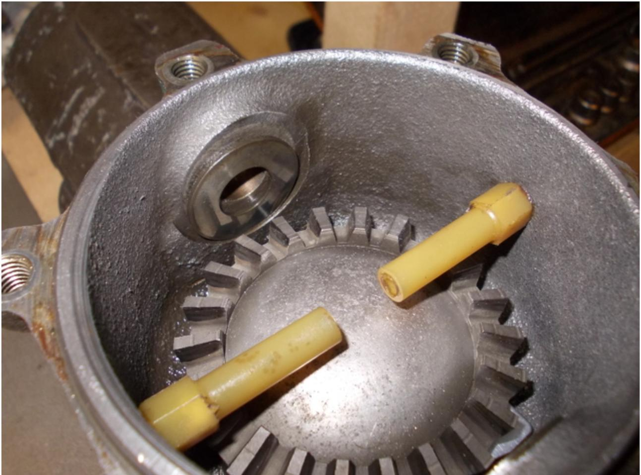
Nun setzen wir die Kegelräder ein und schieben die Achse durch sie und das Gehäuse.
