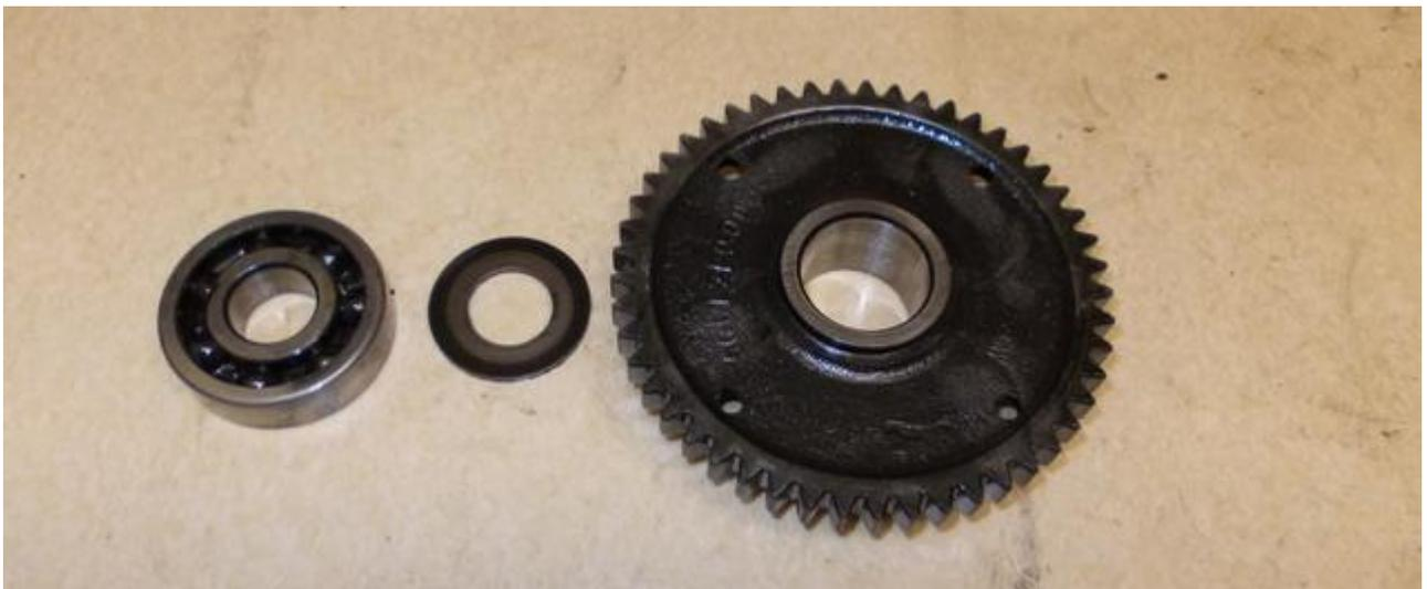
Nach dem grössten Zahnrad, 1.Gang, kommt auch schon der erste Synchronring zum Vorschein. Diese Ringe auch Reibkegel genannt, gab es auch in einer Version komplett aus Aluminium. In der Serie wurden sie für alle Gänge eingeführt und dann wieder, schrittweise, gegen die in Verbundbauweise hergestellten ersetzt. Die haben sich also nicht bewährt bewährt und sollten auch nur im Notfall wiederverwendet werden.
