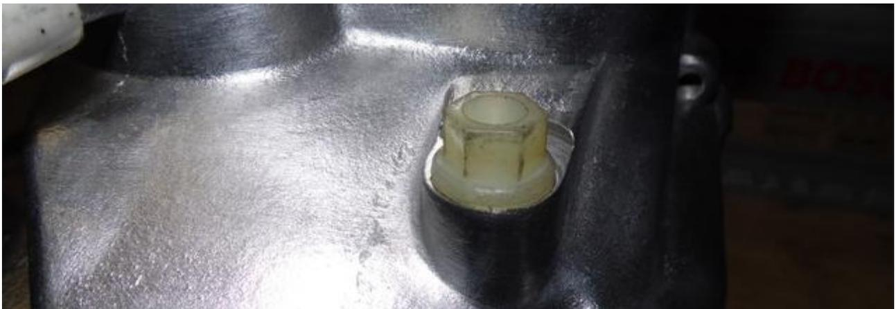
Die Montageöffnungen der Schaltbetätigung werden mit 3 unterschiedlich großen Deckeln verschlossen.
