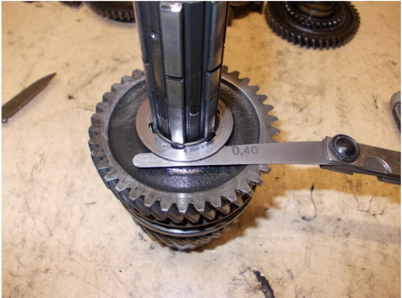
Sprengling abnehmen und Distanzscheibe entfernen. Diese hier hat ziemlich deutliche Einlaufspuren vom Drahring, ich werde beim Zusammenbau mal eine neue, gleichdicke Scheibe, probieren.
