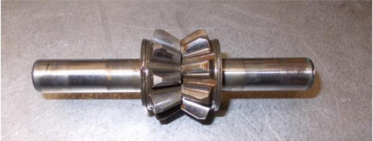
Die Anlaufscheiben der Kegelräder ins Gehäuse einsetzen.
