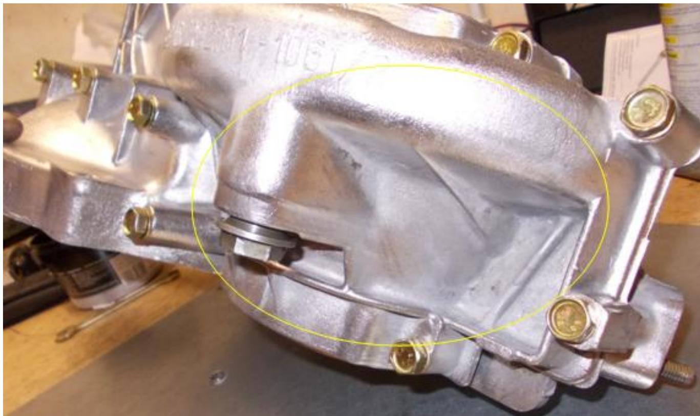
Ansicht eines Getriebe mit Ölfüllmenge 1,5 Liter:
