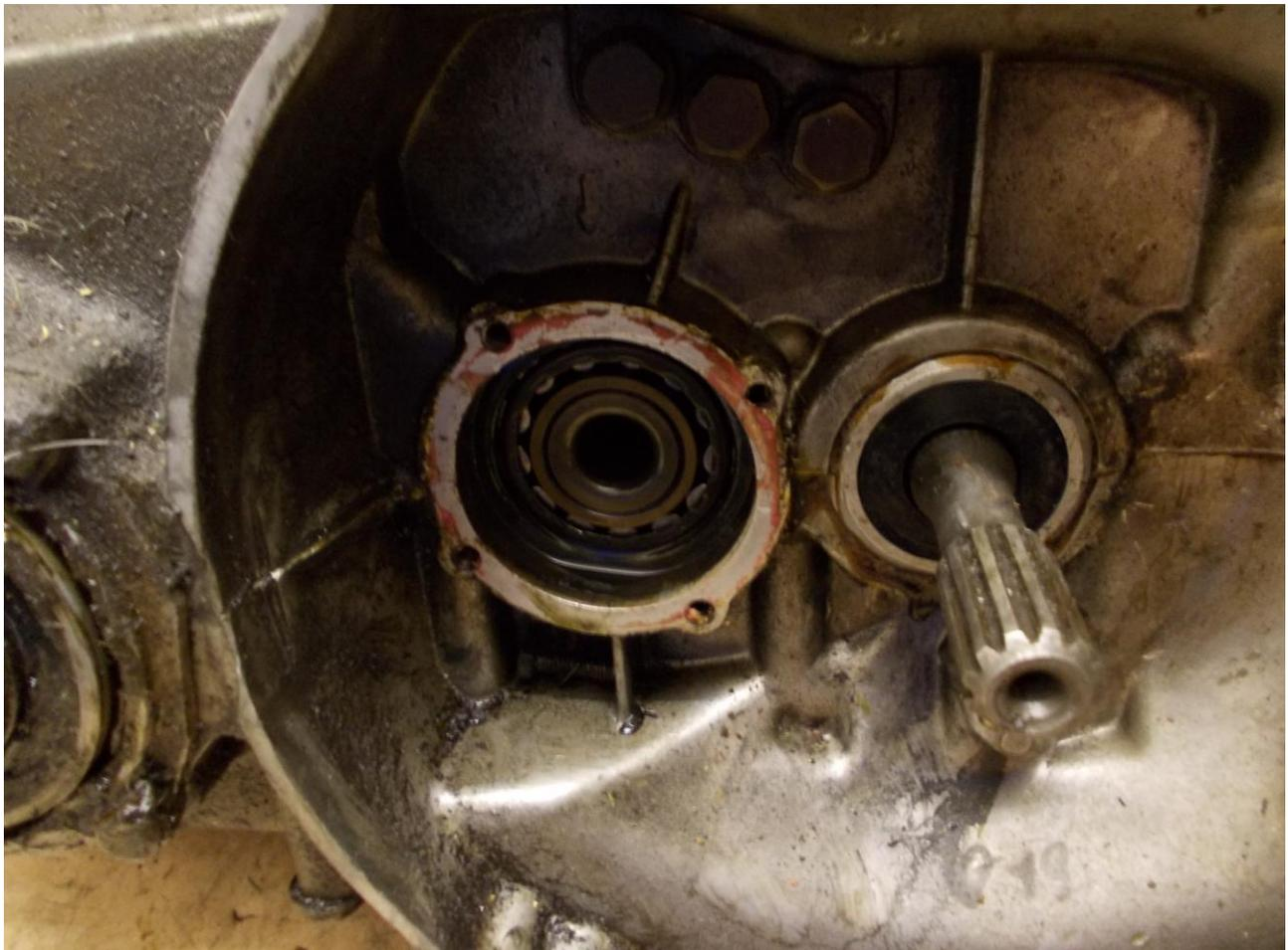
Da es sich hier um ein Getriebe mit geschraubten Simmerringhaltern handelt werden diese nun entfernt. Die späteren, gesteckten, lösen sich beim Trennen der Gehäusehälften.
