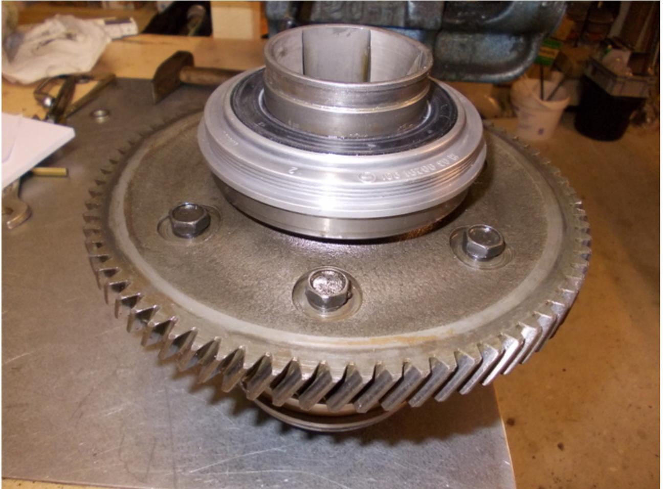
Wer genau hinsieht erkennt oben den Richtungspfeil vorne auf dem Simmerring, der neben dem Tellerrad muss also gegen den Uhrzeigersinn zeigen.
