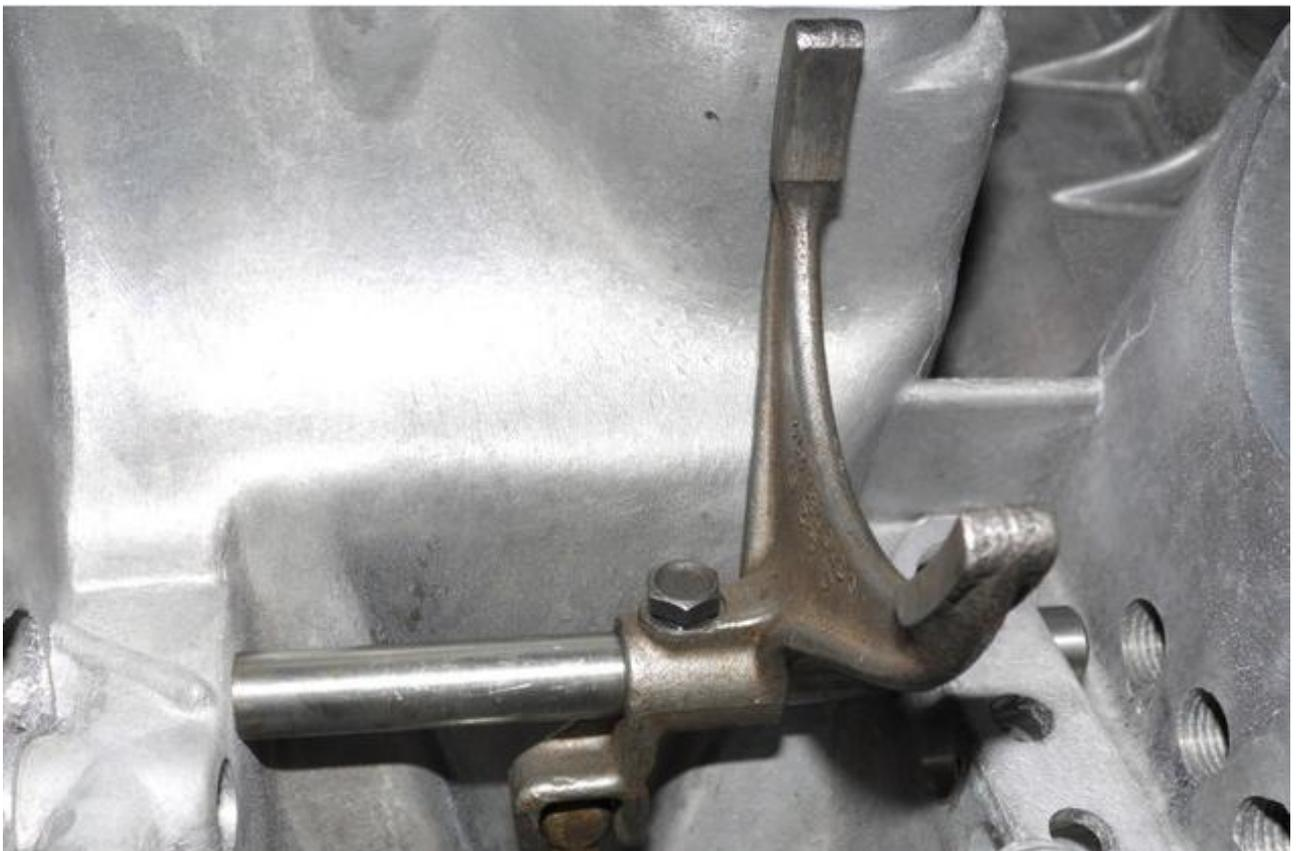
Jetzt das Gehäuse drehen und etwas Fett durch die mittlere, noch freie, Bohrung der Schaltstange 1.-2. Gang in den Querkanal zur bereits montierten Stange einbringen.
