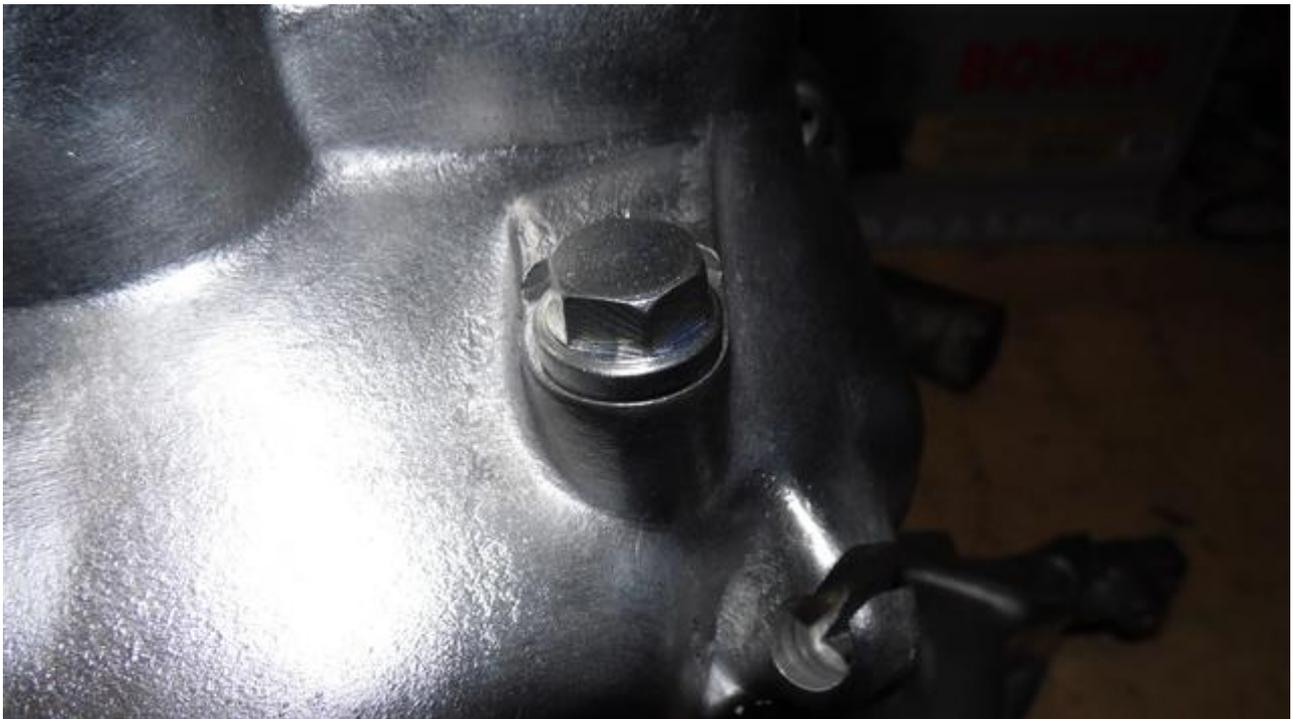
Neuere Getriebe haben einen aus Kunststoff ohne Dichtung.
