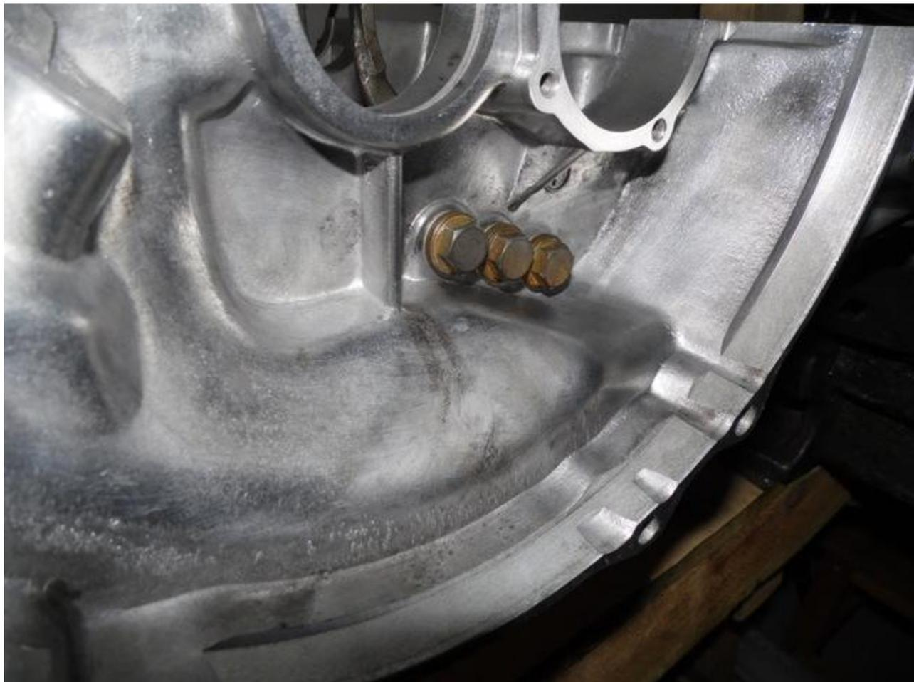
Das Zwischenrad für den Rückwärtsgang in die Tasche der Schaltgabel, wie gezeigt, einlegen und die Achse des Rückwärtsganges mit der Querbohrung voran ins Gehäuse, und durch das Rad einführen. Die Achse mit der Schraube M6x35 mit untergelegtem Sicherungsblech anschrauben und das Blech umlegen.
