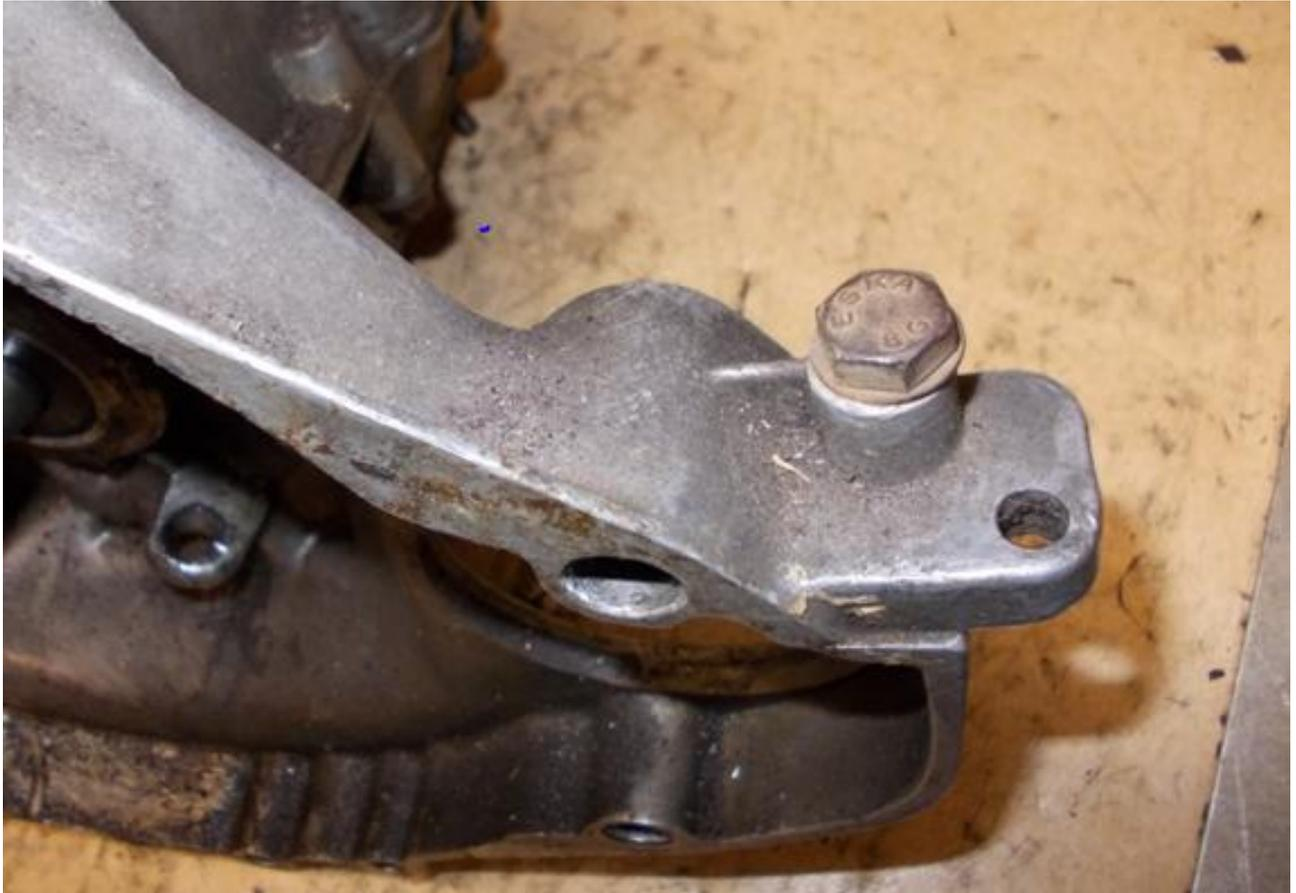
Getriebe umdrehen und die restlichen Gehäuseschrauben entfernen.
