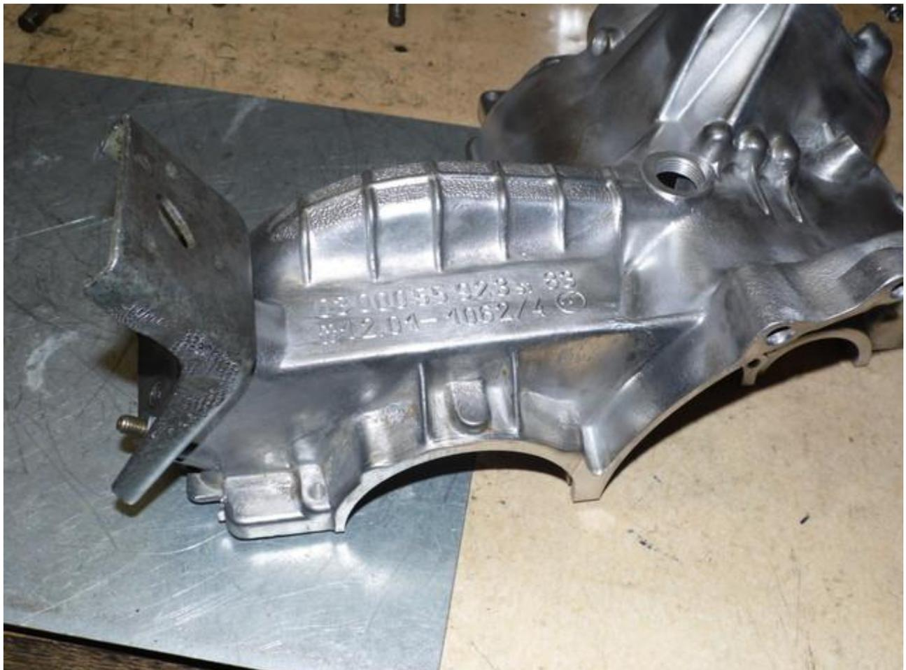
Als Nächstes wird die Schaltwelle mit dem Schaltfinger eingebaut. Die Blechhülse für die Welle ist im neuen Gehäuse schon drin, die Welle muss sich leicht darin bewegen lassen. Wenn nicht dann ist die Hülse innen rostig und muss ausgebürstet werden.
