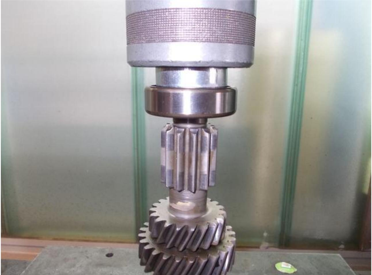
Wellendichtring in den Haltering einpressen, ebenfalls mit etwas Kleber, und den Ring dann auf die Welle schieben. Um die Dichtlippe nicht zu beschädigen diese etwas einfetten und die Verzahnung der Welle mit Papier abdecken.
