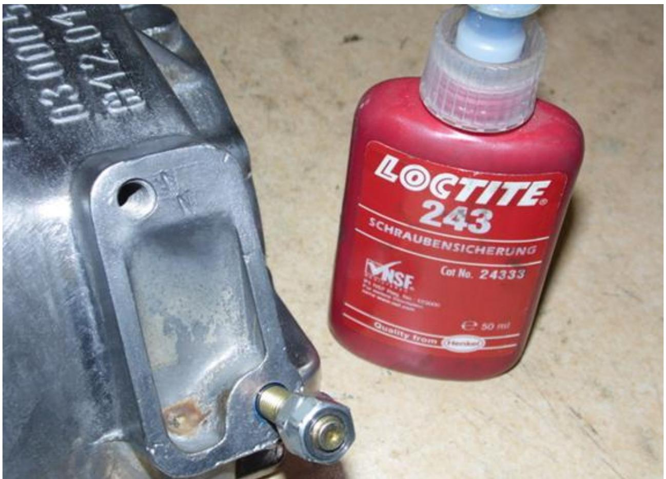
Nun kann der Montagewinkel dort anschrauben werden, um das Oberteil im Schraubstock einzuspannen. Dazu verwende ich jeweils einen alten Montagewinkel.
