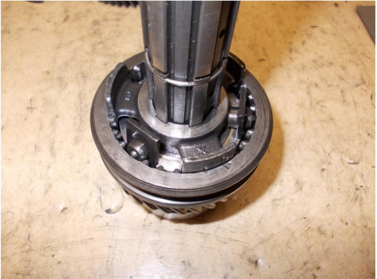
Syncronring für den 3. Gang in die Klinken einsetzen, nun mit dem Rand nach oben.
