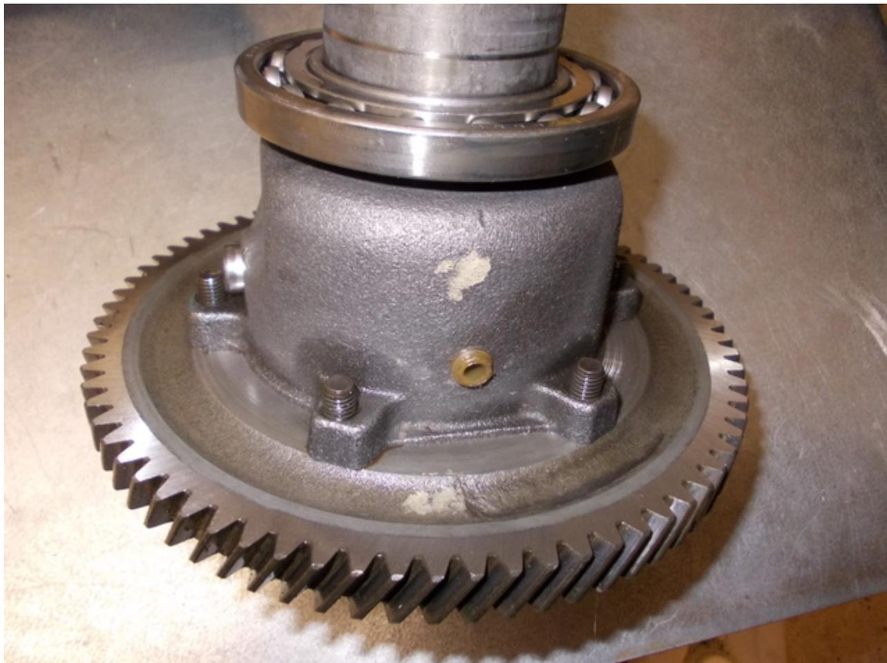
Die Schrauben mit Federringen einsetzen. Hier sind alle 6 gleich lang, manchmal gibt es 4 kürzere und 2 längere Schrauben. Die längeren kommen dann neben die Ausgleichradachse und verhindern somit deren Herausrutschen.
