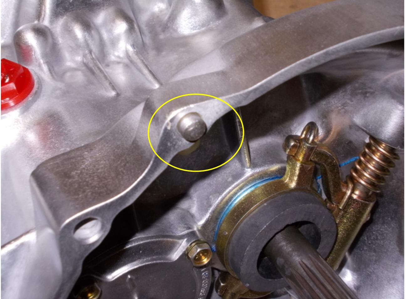
Öl einfüllen, 1,3 Liter sind es immer. Bei älteren Getrieben ist es mehr, im Zweifelsfall die Ölkontrollschraube weglassen und so lange ganz langsam einfüllen bis es beginnt herauszulaufen. Nach einer halben Stunde nochmals kontrollieren, das Differential hat sich gefüllt und damit ist der Ölstand im Getriebe wieder gesunken.
