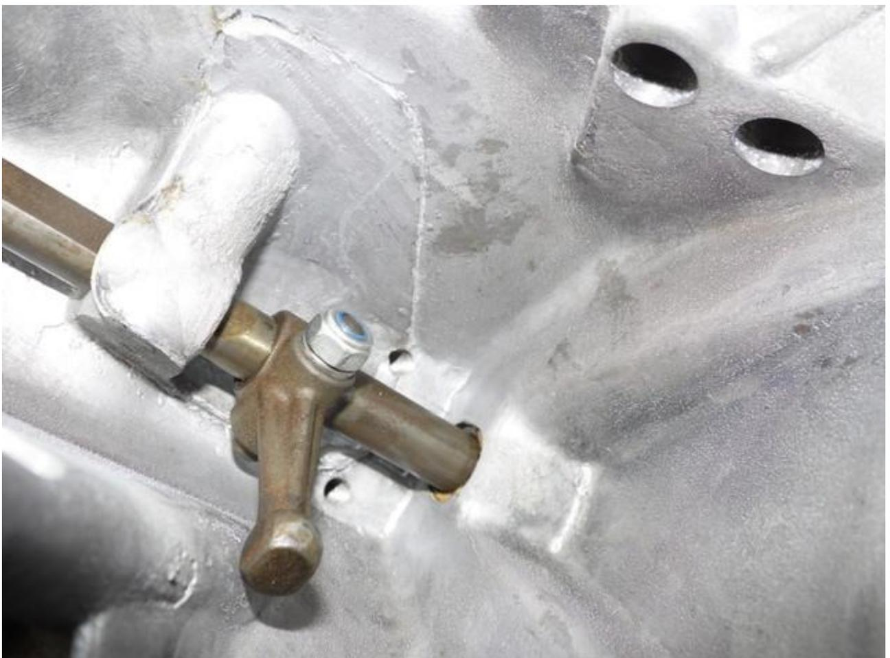
Die 3 Schaltstangen der Schaltgabeln sind an beiden Enden mit Kugeln bestückt. Hier im Überblick
