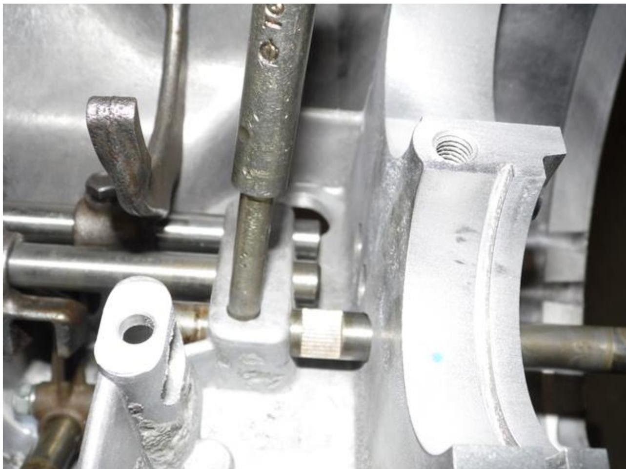
Schaltgabel des Rückwärtsganges anschrauben, den Schaltfinger in eine Gabel einfädeln und der Reihe nach alle 5 Gänge durchschalten.
