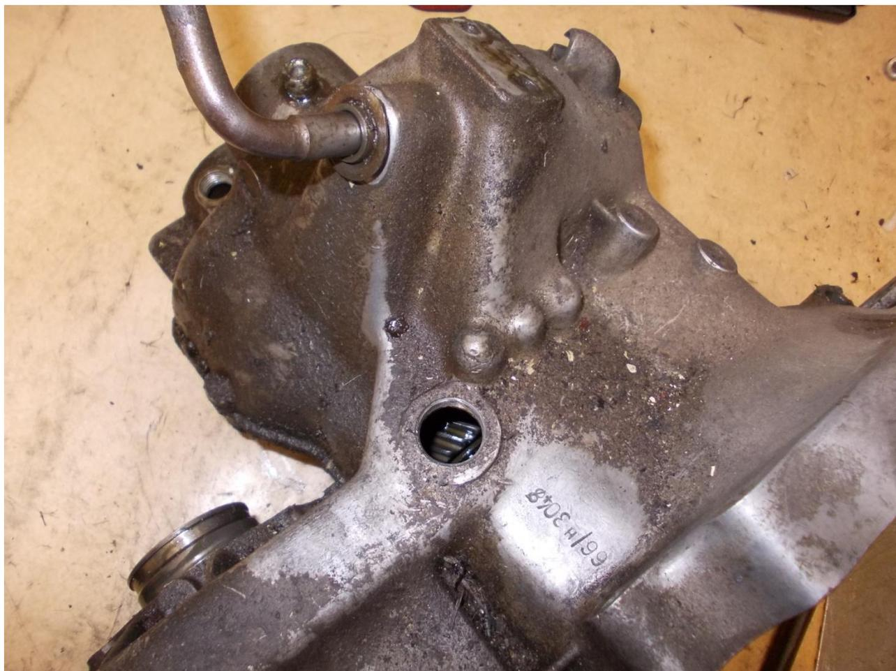
Die Gehäuseschraube M8 in der Nähe der Anlasserbefestigung herausdrehen, sie ist die einzige die von oben geschraubt ist und wird sonst gerne vergessen.
