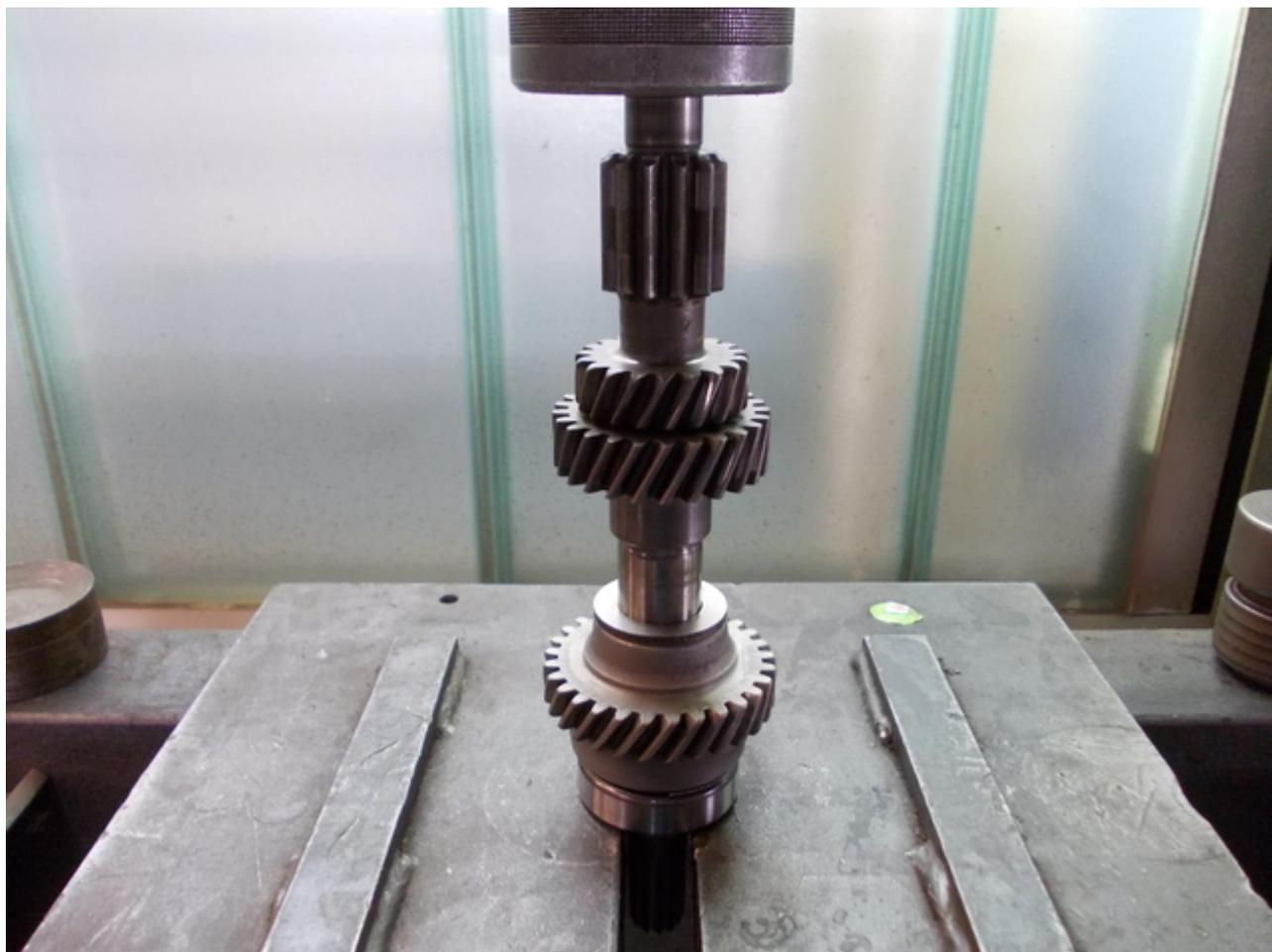
Anschliessend, ebenfalls mit einer Hülse um wirklich nur auf den Innenring des Lagers zu drücken, wird das 2. Kugellager aufgespresst.
