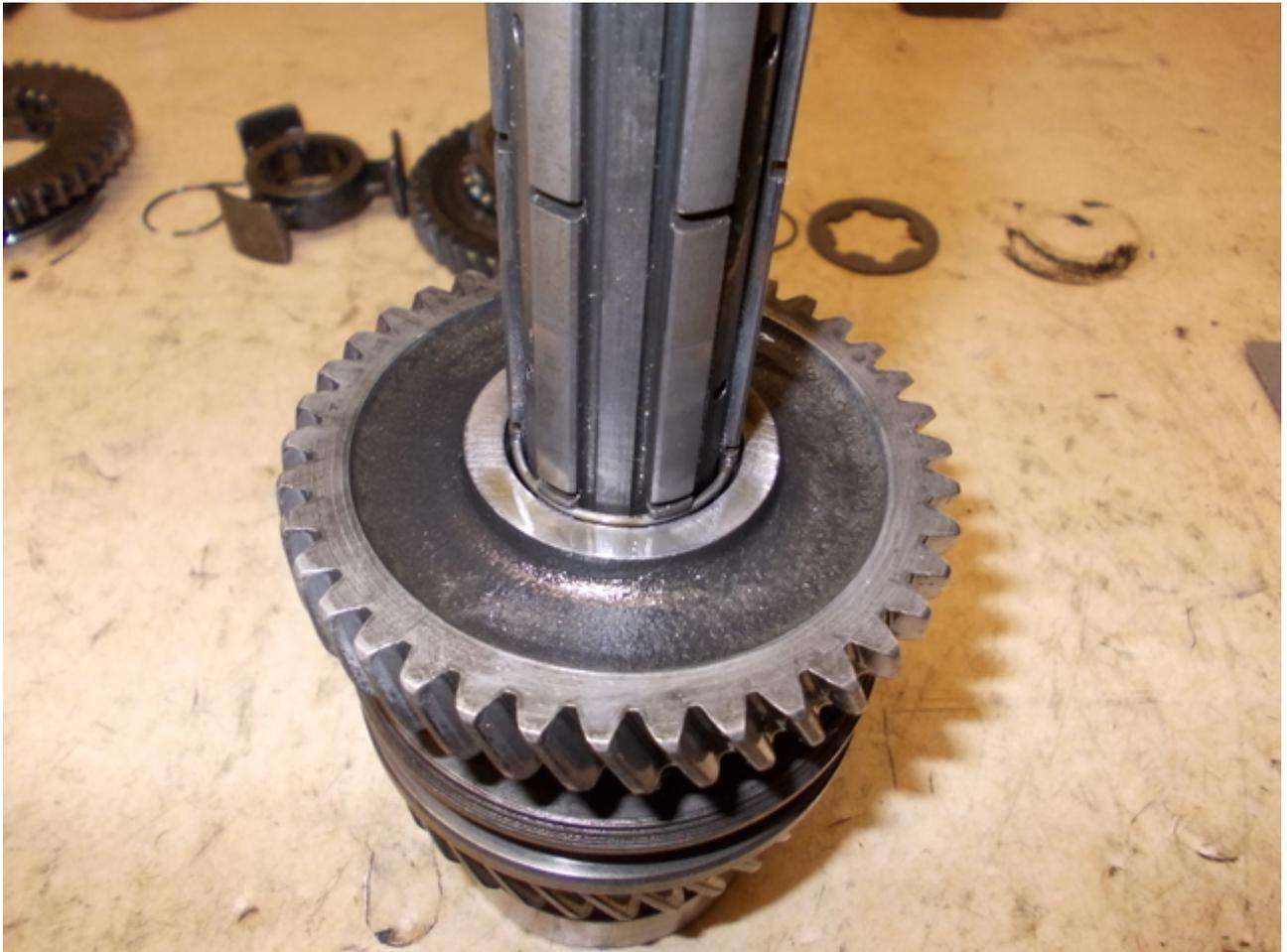
Nun wird der Bereich der Welle korrekt abgestimmt. Voraussetzung dafür ist eine gewisse Auswahl an Abstimmsscheiben. Es gibt sie von 1,5 bis 2,0 mm Dicke.
