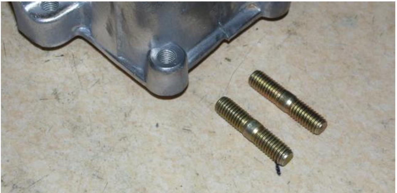
Da die Bohrungen bis in den ölgefüllten Innenraum reichen, und damit sie sich die Schrauben nicht lockern können und später Öl auslaufen kann, werden diese eingeklebt.
