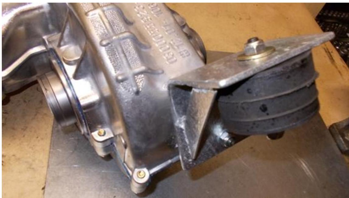
Nun fehlt nur noch die Ölkontrollschraube, M6, oder bei älteren Gehäusen M8, mit neuem Dichtring.
