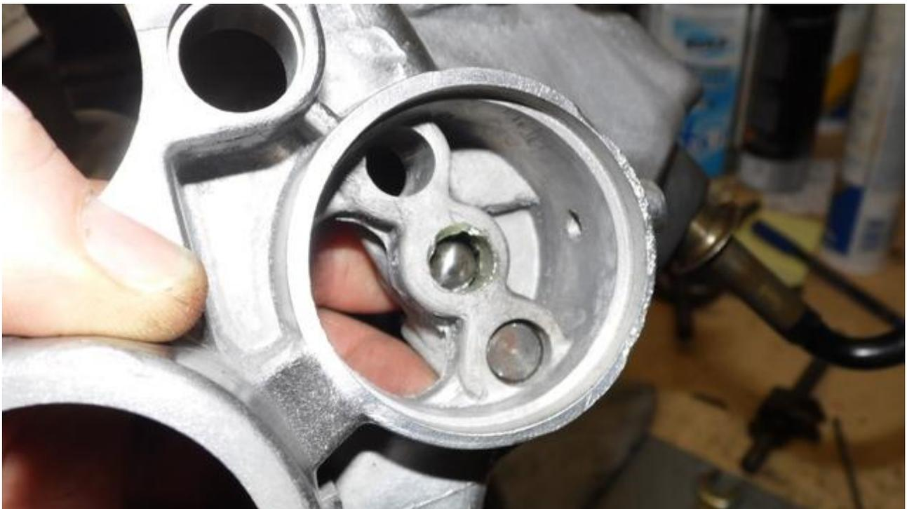
Jetzt die Schaltstange 1.-2. Gang mit der Schaltgabel sinngemäß gleich einbauen.
