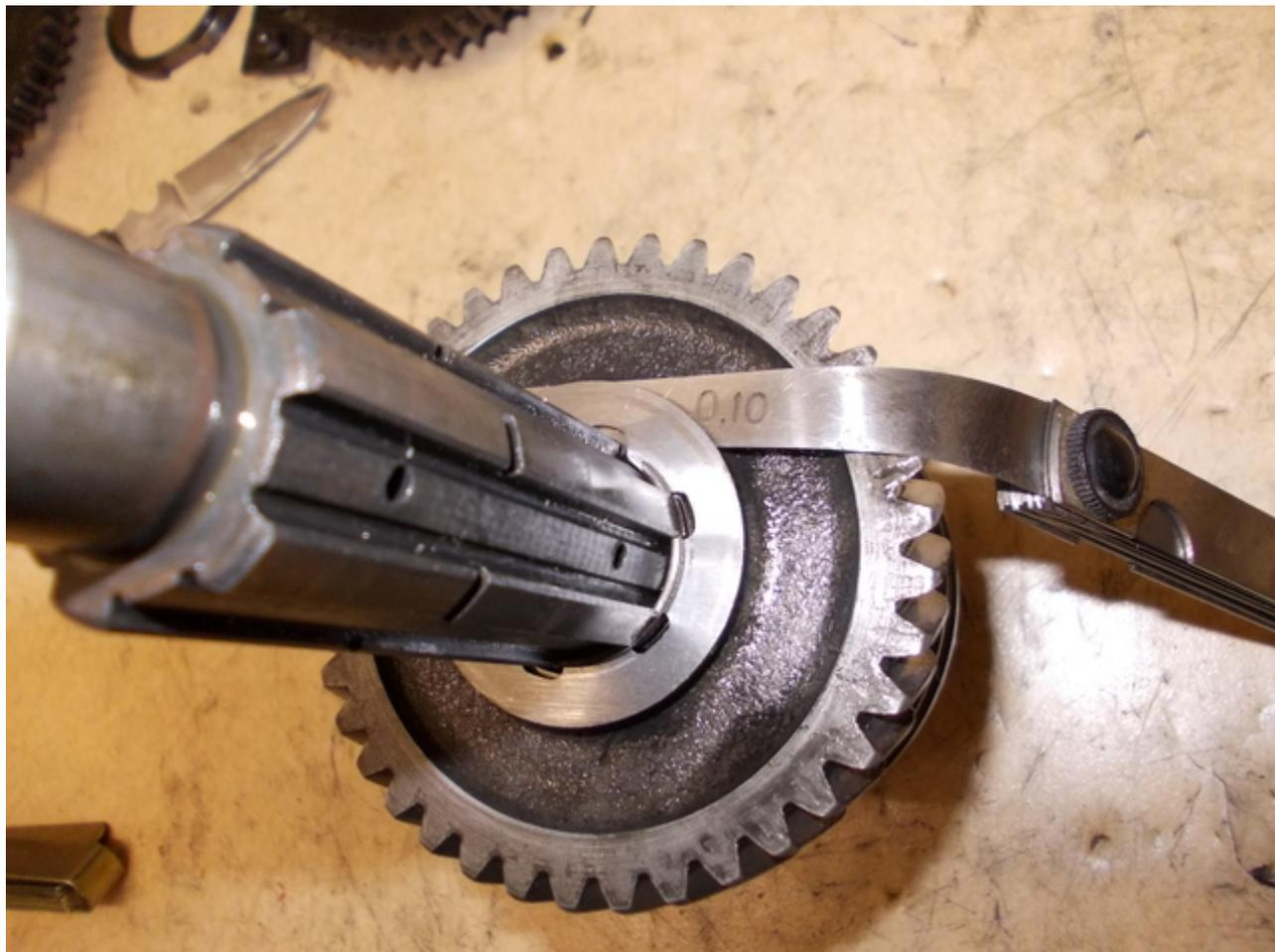
Der Bereich 3. und 4. Gang ist nun fertig, die Schaltmuffe kann in die Leergangstellung geschoben werden.
