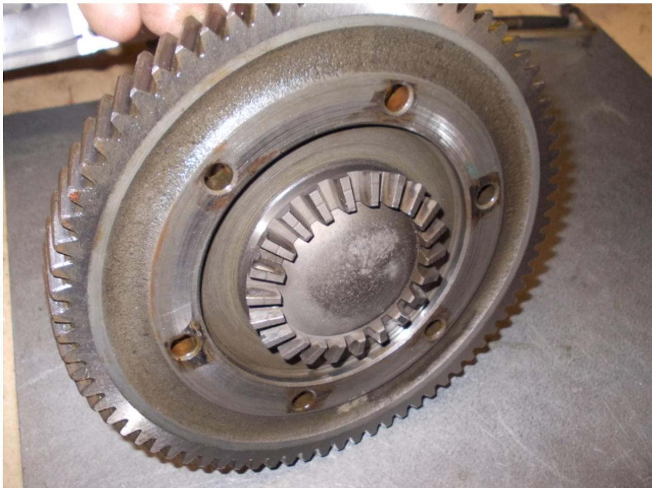
Beides aufsetzen. Dabei auf die Deckungsgleichheit der Farbmarkierungen achten. Diese werden beim Auswuchten der Bauteile aufgebracht oder wir haben sie beim Zerlegen selber gemacht.
