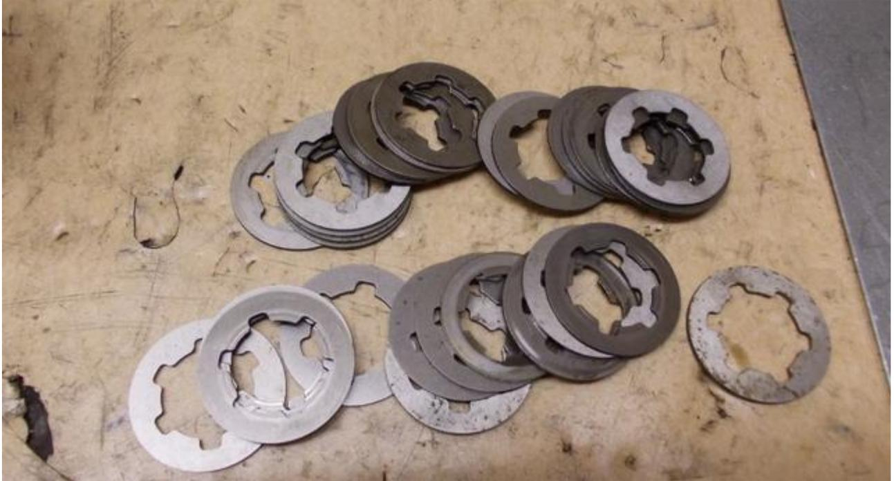
Die ausgebaute Scheibe ausmessen, sie hat 1,6 mm, und davon erstmal eine neue, nicht eingelaufene, einsetzen, Sprengling aufsetzen.
